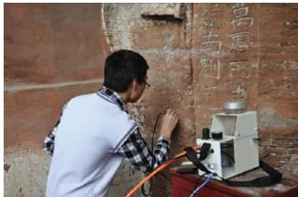
现场保护实验(微粒子喷射清洗)
